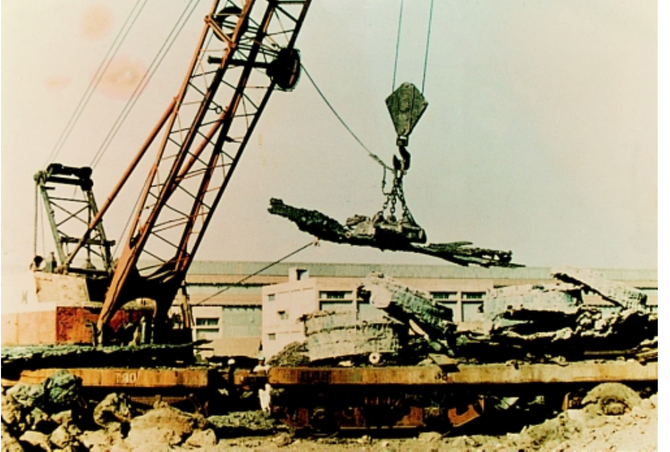
रेल वैन से प्रोसेसिंग के लिए स्क्रैप सामग्री उठाता हिंद मैरिन क्रैन
